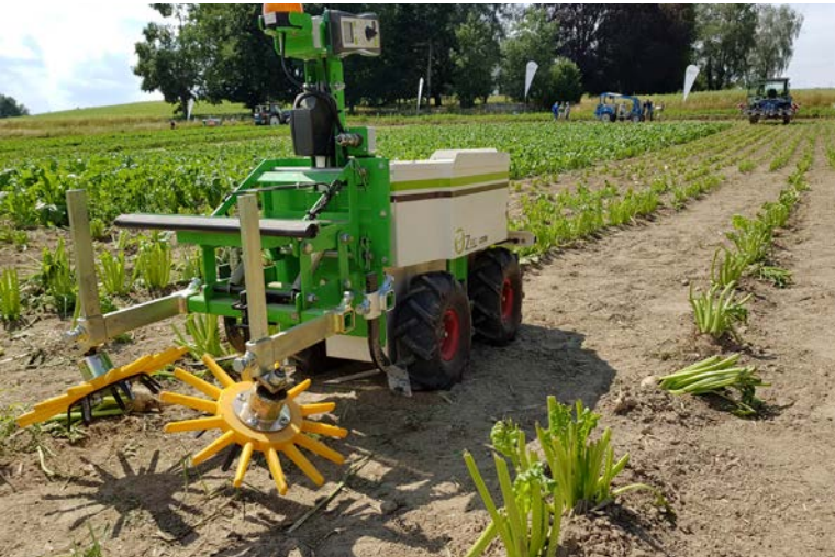
▭ Bild 3: Automatisierte Beikrautregulierung durch Hackroboter (Foto: Beat Vinzent, LfL)
