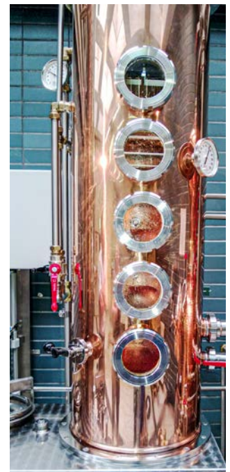
Bild 1: Die Feinbrandkolonne ist das Herzstück der Destille. Hier wird der Alkohol gereinigt und fraktioniert (Fotos: LWG)
