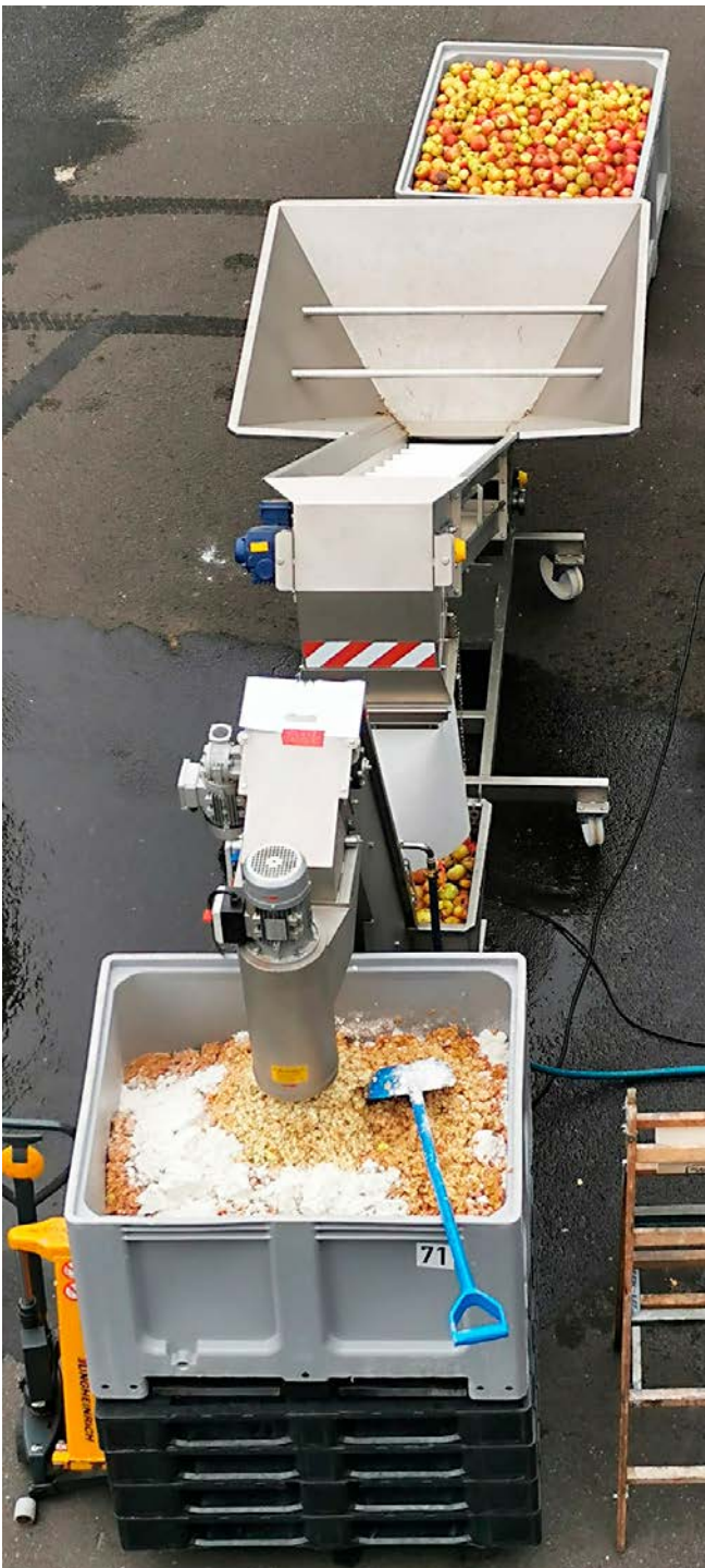
■ Bild: Einmischprozess der Äpfel, Beförderung durch Förderband, anschließendes Waschen und Zermahlen (Foto: Felix Baumann)
