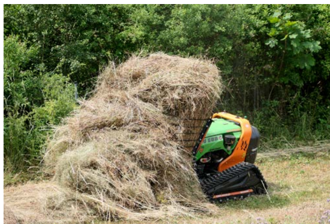
■ Bild 1: Spätgeschnittene Aufwüchse werden mithilfe eines fernsteuerbaren Geräteträgers abgeführt (Foto: Gerhard Hetz, LWG)
