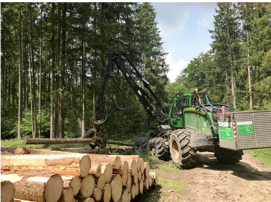
■ Bild 2: Portables Emissionsmesssystem im Heckanbau an einem Forstharvester John Deere 1470G im Rapsölkraftstoffbetrieb
