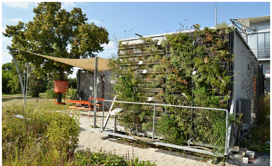
Bild 1: Auf dem Areal der Klima-Forschung-Station (KliFoStat) am Würzburger Hubland steht nicht nur die Wandbegrünung (hier Blick auf die Südwand) auf dem Prüfstand. Auch verschiedene Arten der Dachbegrünung und eine bepflanzte Versickerungsmulde im Vordergrund sind Bestandteil einer blau-grünen Infrastruktur. (Fotos: Dr. Katja Arand)
