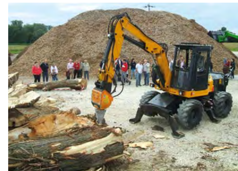
Die Zuschauer sind beeindruckt: Das Schneckengetriebe des Kegelspalters wird auch mit extrem dicken Stämmen fertig.
