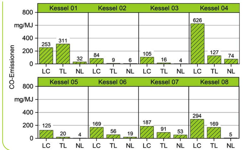
Abbildung 2: Kohlenmonoxid-Emissionen während des Betriebs von acht verschiedenen Pelletkesseln LC – Lastzyklus-Methode, TL – Typenprüfung nachgestellt bei Teillast, NL – Typenprüfung nachgestellt bei Nennlast
