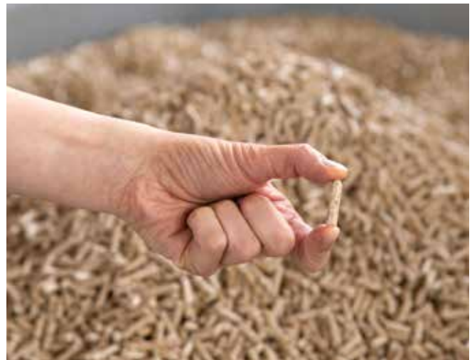
✔ Bild: In der Praxis sind nach Norm Pelletlängen von 3,15 mm bis maximal 40 mm zulässig. Hier veranschaulicht ein eher längeres Pellet in Relation zur menschlichen Hand (Foto: Ulrich Eidenschink, TFZ)
