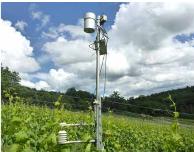
▣ Bild: Die Wetterstation liefert Echtzeitdaten für Temperatur, Niederschlag und Blattfeuchte. (Foto: LWG)
