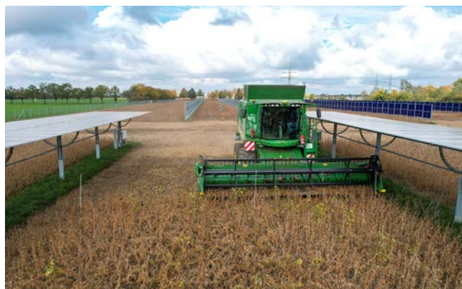
▣ Bild 4: Mähdrescher bei der Sojaernte. Bei ausreichender Arbeitsbreite ist eine problemlose Ernte bis nah an die Aufständerung und ohne manuelle Verstellung der Module möglich. (Foto: Daniel Eisel, TFZ)
