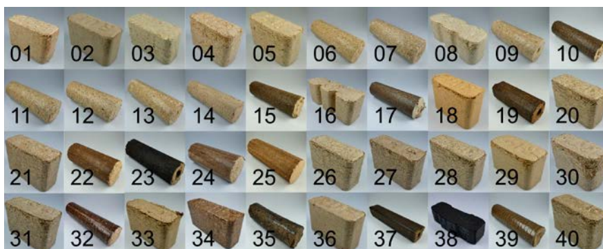
Bild 2: Die 40 Briketts unterschieden sich stark hinsichtlich Farbe und Form (38 x Holzbriketts, 1 x Rindenbrikett Nr. 34 und 1 x Braunkohlebrikett Nr. 38). Die Nummerierung erfolgte anhand des Aschegehalts, wobei Brikett Nr. 01 den niedrigsten und Brikett Nr. 40 den höchsten Wert hatte.
