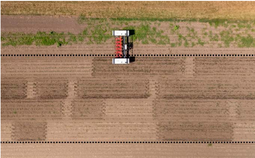
▭ Bild 3: Der Agrobot Robotti im Einsatz zum teilflächenspezifischen Hacken nach mit der Drohne erhobenen Unkrautkarten im Projekt EWIS2; Testfläche markiert durch gepunkteten Rahmen.
