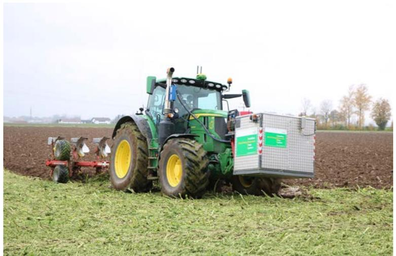
Bild 1: ResiTrac beim Pflügen mit installierter Emissionsmesstechnik
