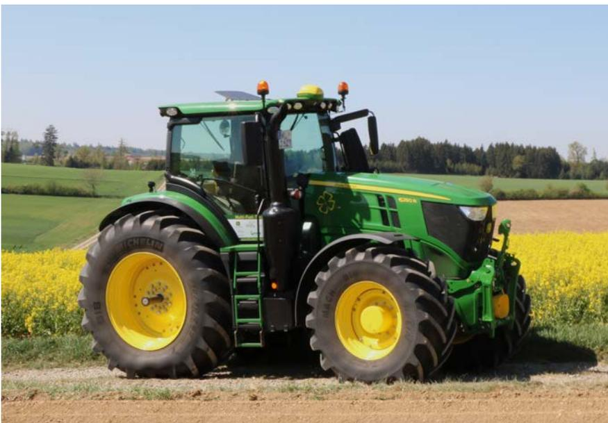
■ Bild 1: Der JD 6250 R ist ein Prototyp des Landmaschinenherstellers John Deere und fährt wahlweise mit Rapsölkraftstoff, Biodiesel und HVO. (Foto: TFZ)
