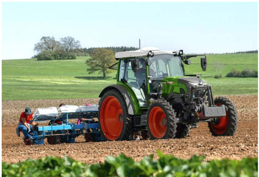
Bild 3: Der Fendt e100 Vario läuft zu 100 Prozent batterieelektrisch und wurde beispielsweise für den Einsatz im Gemüsebau entwickelt. (Foto: AGCO/Fendt)
