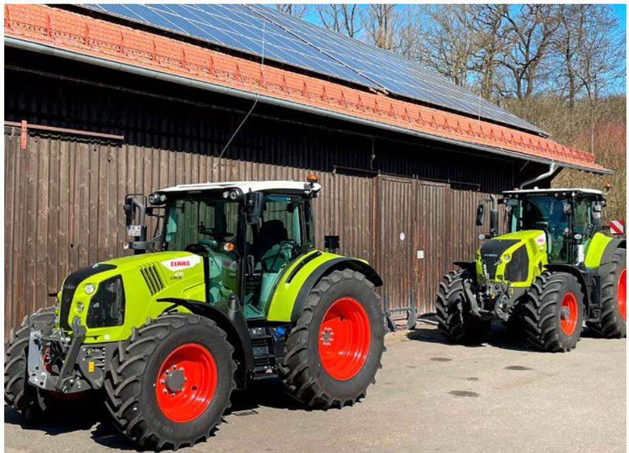
Bild 1: Die Traktoren CLAAS Arion 470 und CLAAS Axion 830 CMATIC der Abgasstufe V für den Testbetrieb mit B100 auf dem Bayerischen Staatsgut Almesbach (Fotos: TFZ)
