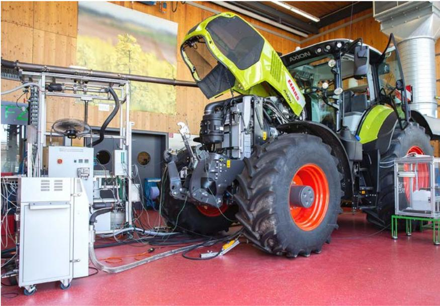
Bild 2: Biodieseltraktor CLAAS Axion 830 CMATIC am Traktorenprüfstand des TFZ
