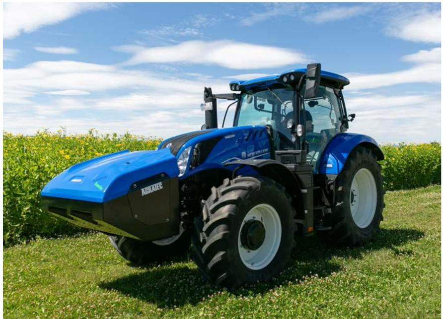
Bild 2: Der T6.180 CNG-Traktor von New Holland wird mit Biomethan betrieben. (Foto: TFZ)
