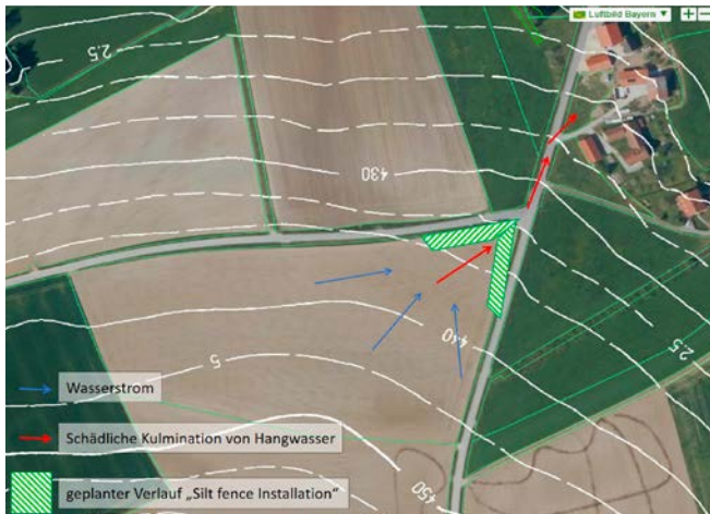
Bild 6: Weiterer geplanter „Silt fence“-Standort (Foto: Theresa Scherm)
